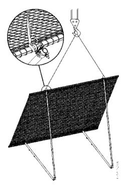
Figure 19. Lifting a safety net fan
